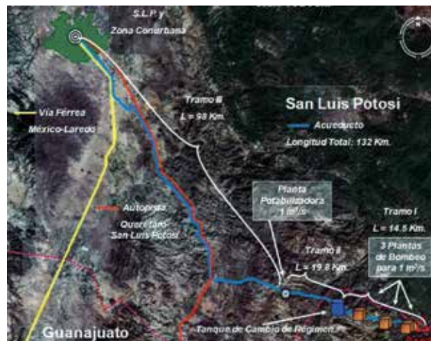
Figura 2. Secciones del acueducto El Realito
